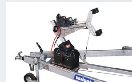
El-spil med wire. Inkl. batteri og batterikasse. Monteret. Warn 4000. Trækkapac. 1.814 kg Varenr. 50192 Trådløs fjernbetjening Varenr. 41556 VR EVO 8. Trækkapac. 3.600 kg Varenr. 50191 inkl. trådløs fjernbetjening
