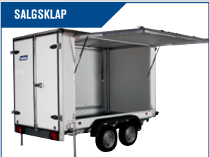
Stor salgsklap i siden med stormsikret støddæmpere.
