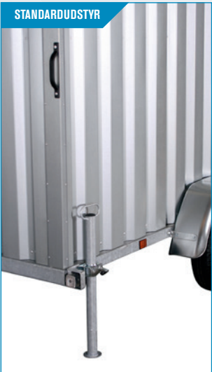
4 stk. støtteben og bugsergreb giver stabilitet og let manøvrering.
